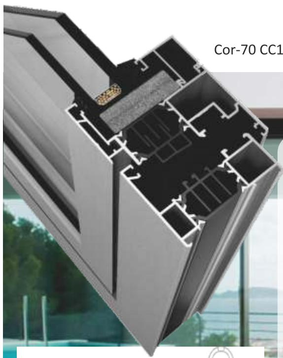
Systém pántového okna s konštrukčnou hĺbkou rámu 70 mm, ktorého silné izolačné schopnosti a nízka hodnota prieplustnosti tepla na ráme, len  $1,7 \text{ W/m}^2$ , sú dosiahnuté vďaka dokonalej kombinácii dizajnu hliníkových profilov, polyamidových tyčí šírky 35 mm, dutého tesnenia z E.P.D.M. materiálu a systému vypíňania vnútorného obvodu drážky pre sklo penou z polyolefínu.
