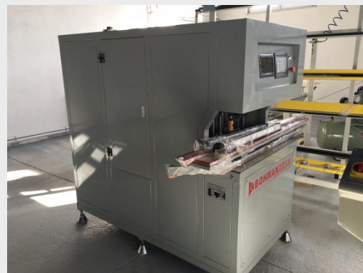
AUTOMAT NA ČISTENIE ROHOV S CNC RIADENÍM
