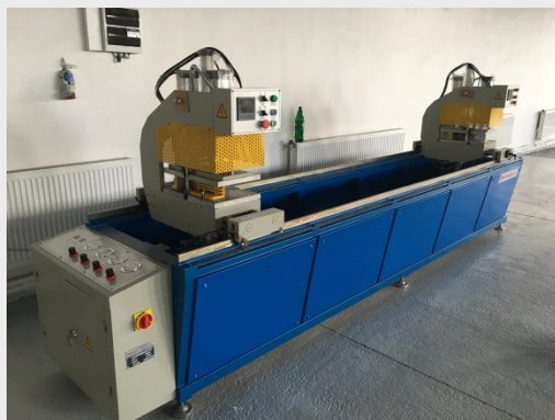
DVOJHLAVÁ ZVÁRAČKA PROFILOV S NASTAVITEĽNÝM UHLOM PRE PVC
