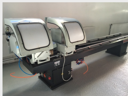
UNIVERZÁLNA PÍLA DVOJKOTÚČOVÁ NA PVC A HLINÍKOVÉ PROFILY
