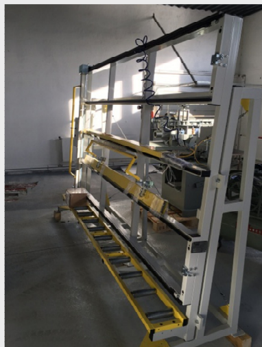
ZASKLIEVACÍ STOJAN K VÝROBE ZIMNÝCH ZÁHRAD NA PVC A HLINÍKOVÉ OKNÁ
