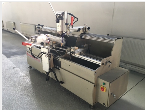
KOPÍROVACIA FRÉZA ZÁMKOV S TROJVRTÁKOM
